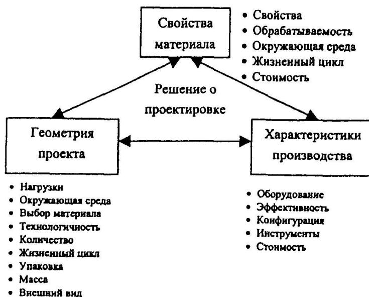
Рис. 1. Взаимосвязь между свойствами материала, геометрией проекта и характеристиками производства. Общая стоимость, масса и использование деталей в конструкциях определяются этими тремя проектными факторами
